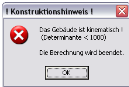
Bild 8-10 Hinweis: Gebäude kinematisch
